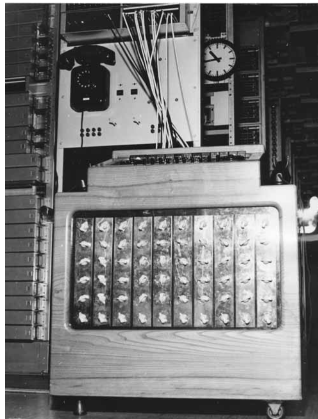
Puhelinyhdistyksen keskusten vianetsinnässä käytettiin apuna robottipuhelimia, jotka soittivat jatkuvasti eri numeroihin ja testasivat yhteyden muodostumista. Jos yhteydessä havaittiin vika, robotti antoi hälytyksen korjaushenkilöstölle. Laite on nykyisin Puhelinmuseon kokoelmissa. (Kuva: Puhelinmuseo / Erkki Lahtinen)
