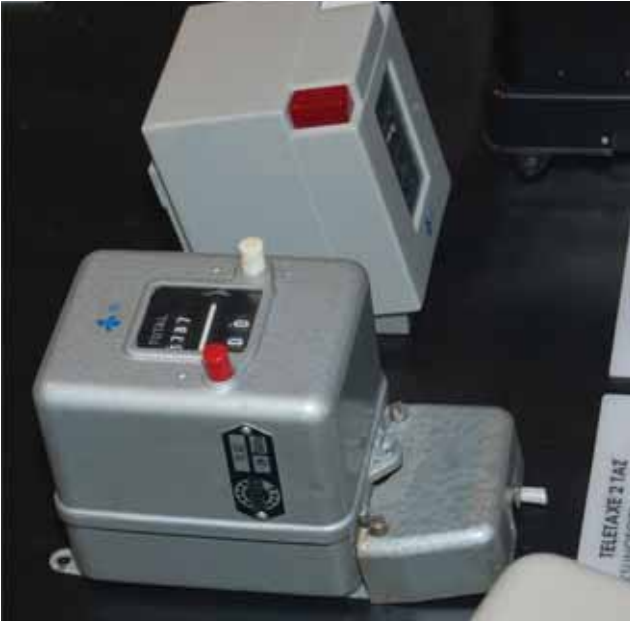
Teletaxe-maksunosittimia käytettiin silloin, kun haluttiin tietää, paljonko esimerkiksi ulkomaan- ja kaukopuhelut maksavat. Nyt laitteet ovat päätyneet Puhelinmuseon kokoelmiin.
